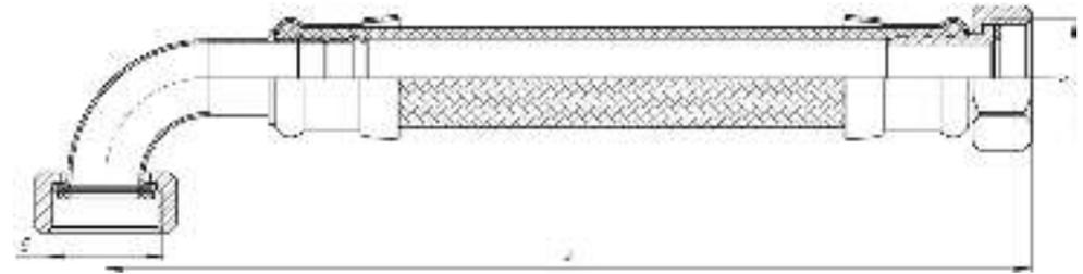
Рисунок 7 – Габаритные и присоединительные размеры подводки вн-вн, угловая
