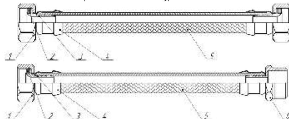
Рисунок 2 – Общий вид и конструкция подводки ¾ "
