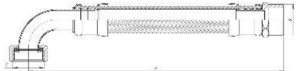
Рисунок 8 – Габаритные и присоединительные размеры подводки вн-нар, угловая
