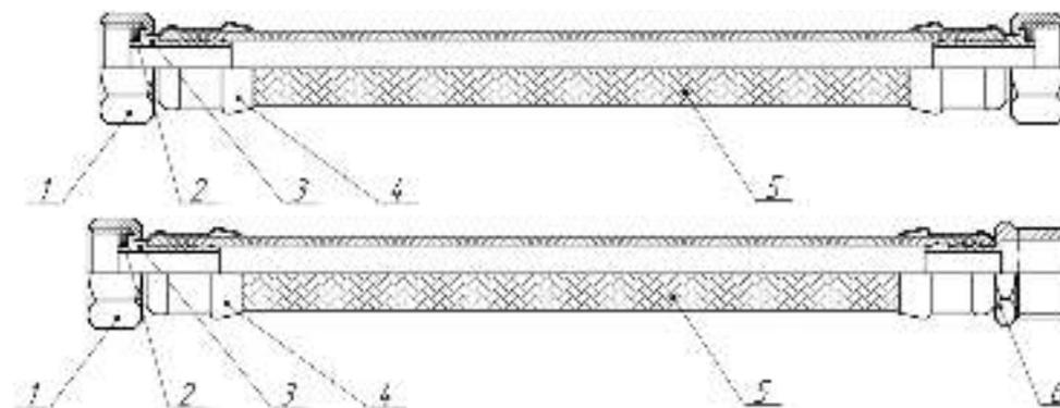
Рисунок 1 – Общий вид и конструкция подводки ½ "
