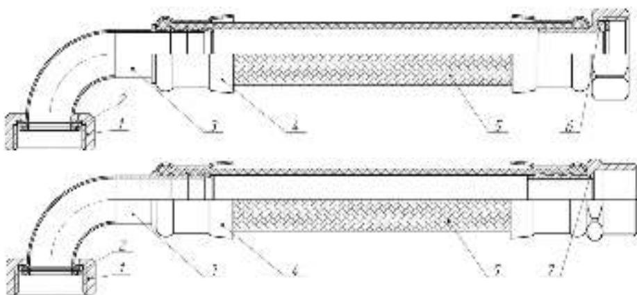
**Рисунок 4** – Общий вид и конструкция подводки 1", угловая
